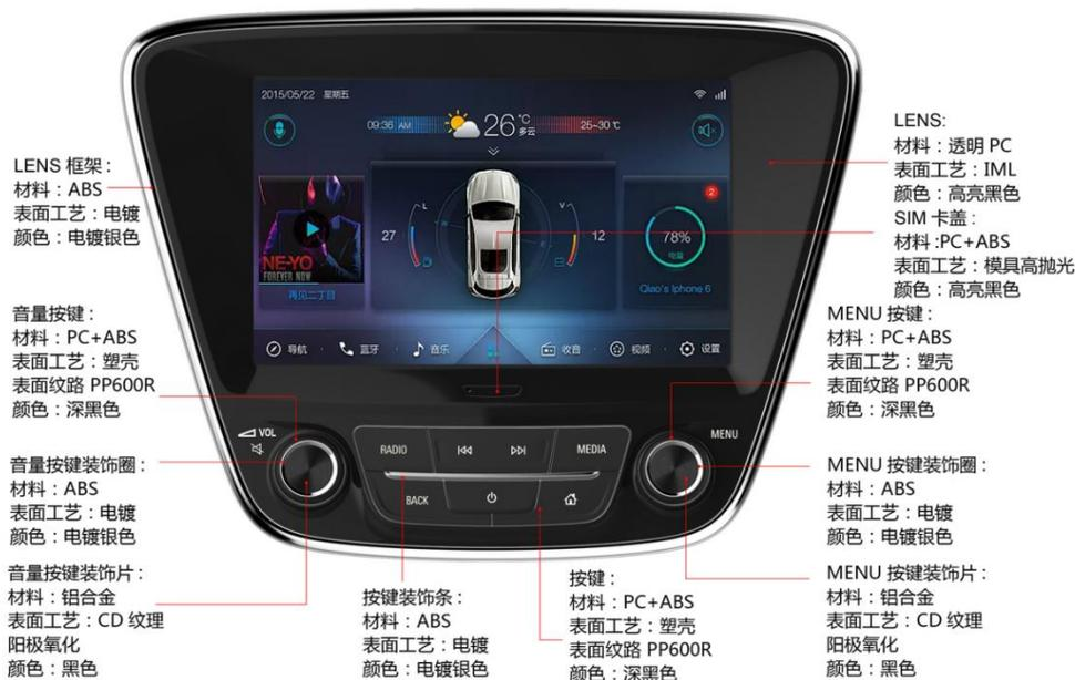
K218项目产品采用了高通8917方案，搭配8寸IPS显示屏，对原车车机功能进行了大幅度升级。搭载Android 6.0操作系统，可轻松实现收音机，wifi蓝牙传输，音视频播放等娱乐功能、支持手机互联，Apple Carplay和百度Carlife。可以用自身模块实现在线高德地图导航和在线APP使用。
